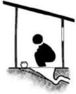
Pour flush toilet
