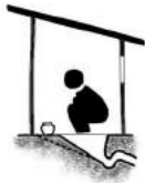
Pour flush toilet
